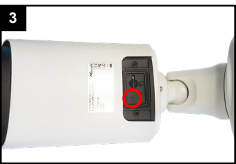
3 Für Reset: Fünf Sekunden lang die Taste gedrückt halten.
