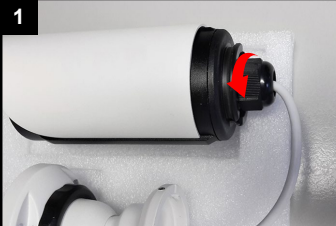
1 Verschraubung durch Drehen entgegen dem Uhrzeigersinn lösen.
