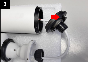
3 Vorsichtig die Rückwand abziehen, ohne das Kabel herauszureißen.
