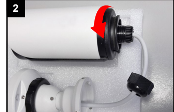
2 Rückwand der Kamera abschrauben.
